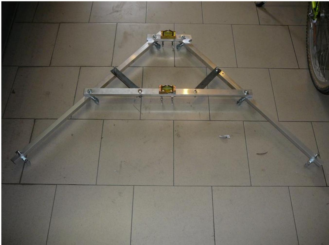
Descritto come ho assemblato il tutto e bloccato diagonalmente con due piattine di ferro, procediamo all'assemblaggio delle canne che sono della lineaeffe da 8 mt e naturalmente i cavallotti vanno dimensionati per il diametro delle canne più la fascetta di plastica per distribuire la presa. Io ho utilizzato un normale tubo per scarichi grigio che è più sottile dell'arancione e va perfettamente alla misura esatta del cavallotto.
